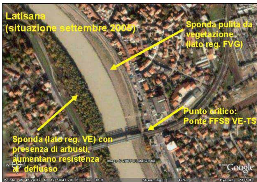
Figure 24: situazione dell'alveo o presso Latisana, vista da satellite (Landsat TM).
